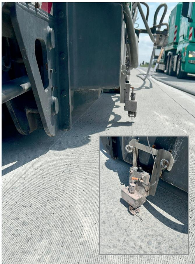
Bild 3 Anbausatz zur Nachrüstung von Grindingmaschinen
