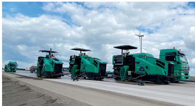
Bild 4 Parallelfahrt von drei Grindingmaschinen
