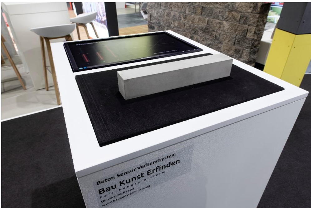
Das Sensorsystem wird materialintegriert verkapselt und in dem Bauteil vergossen. © BetonBild/Görllich
