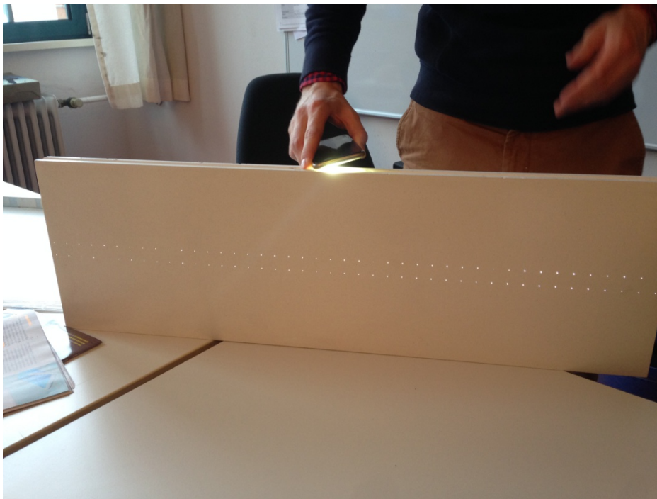
Das integrierte Lichtfasersystem leitet die LED-Lichtimpulse an die Betonoberfläche, und die Lichtpunkte strahlen aus dem Beton heraus. Foto: InformationsZentrum Beton
