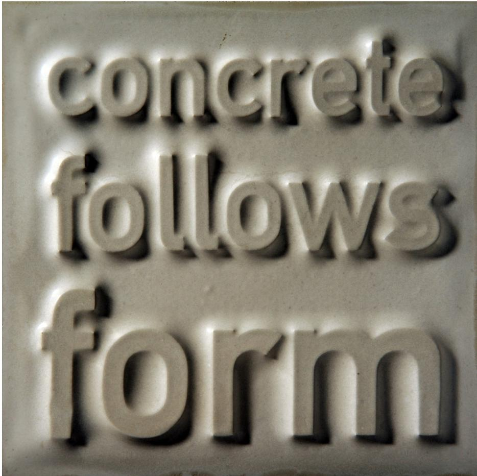
Die Betonschalung wurde mit einer Vakuumtiefziehmaschine hergestellt.
