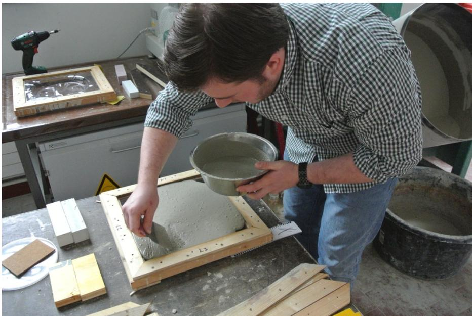
Die fertige Form wird mit selbstverdichtendem Beton ausgegossen. Fotos © Team Prof. Rogall / FH Dortmund
