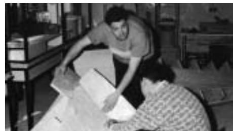
Bild 1.8: Glasfasermatten werden aufgebracht
