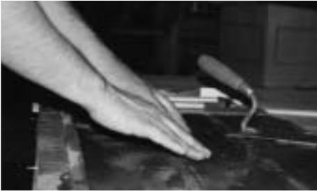
Bild 1.12: Herstellen von dünnwandigen Faserbetonplatten
