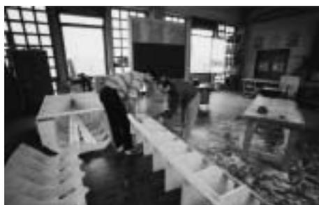
Bild 1.6: Die Schalungsteile werden paarweise zusammengesetzt.
