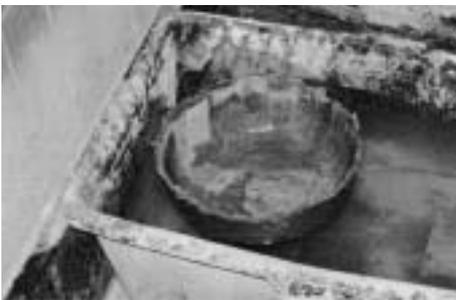
Bild 1.13: Untersuchung der Wasserdichtigkeit
