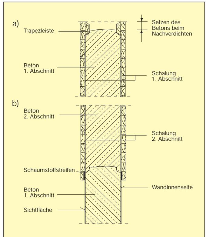
**Bild 8: Arbeitsfuge in Sichtbetonwänden**
