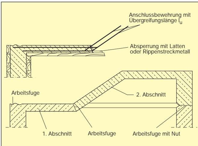
**Bild 12: Arbeitsfugen bei Stahlbetontreppen mit -podesten [2]**
