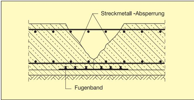
**Bild 4: Arbeitsfuge in einer Fundamentplatte bei wasser- und undurchlässigen Bauwerken [1]**
