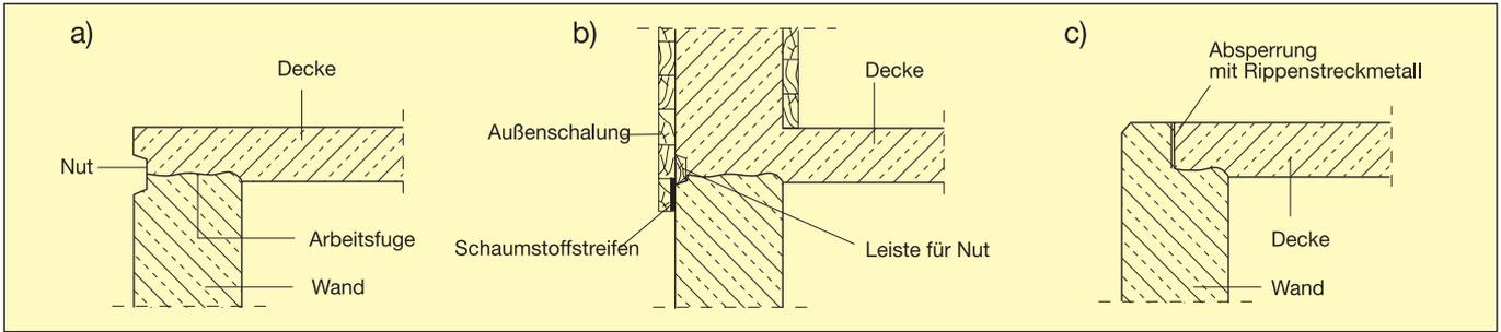
**Bild 11: Arbeitsfugen zwischen Wand und Decke**
