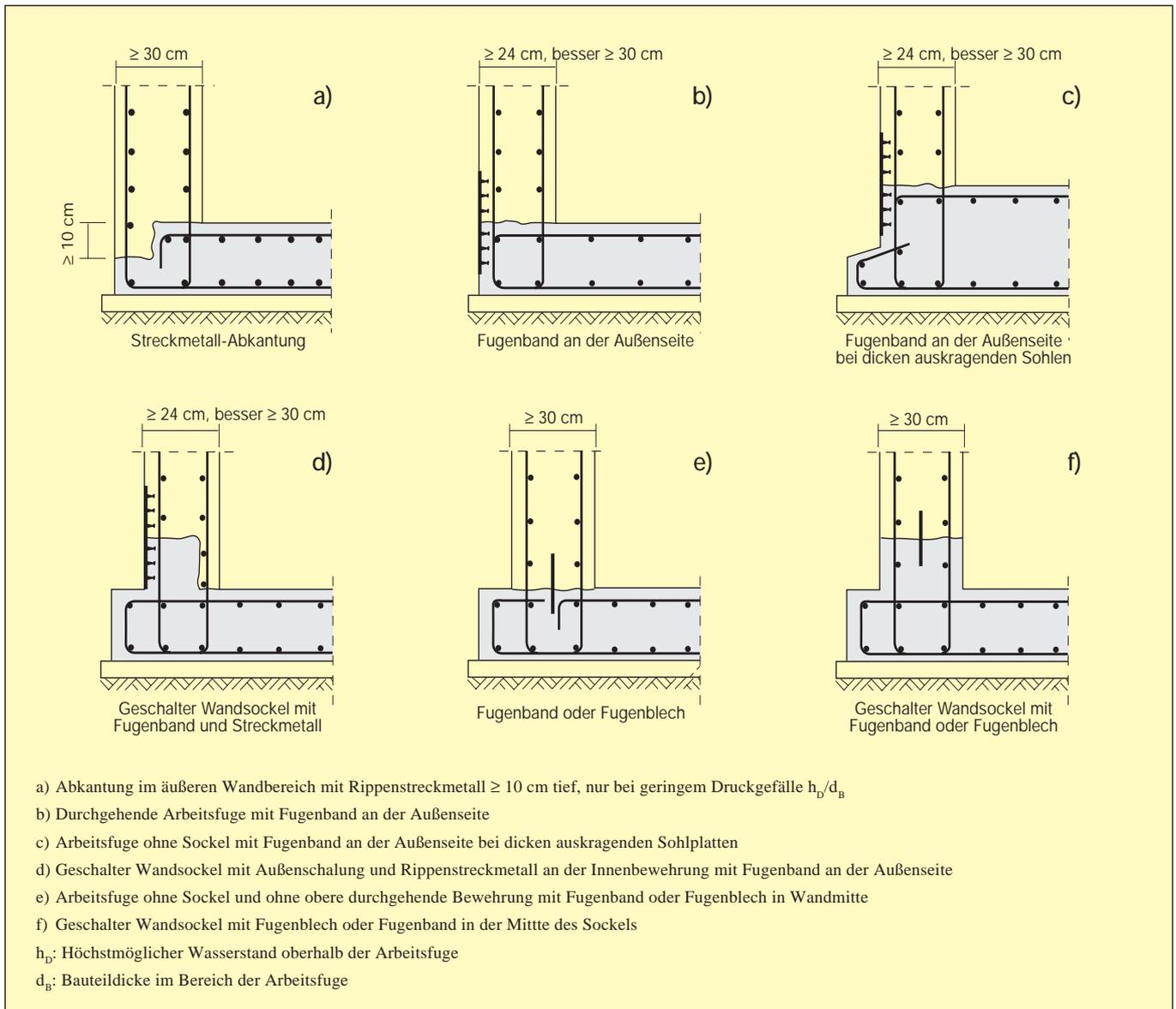
**Bild 2: Arbeitsfugen Sohlplatte – Wand bei Weißen Wannen. Dargestellt sind Fugenabdichtungen mit Fugenbändern bzw. -blechen für die Beanspruchung durch drückendes Wasser bzw. aufstauendes Sickerwasser nach [1]**
