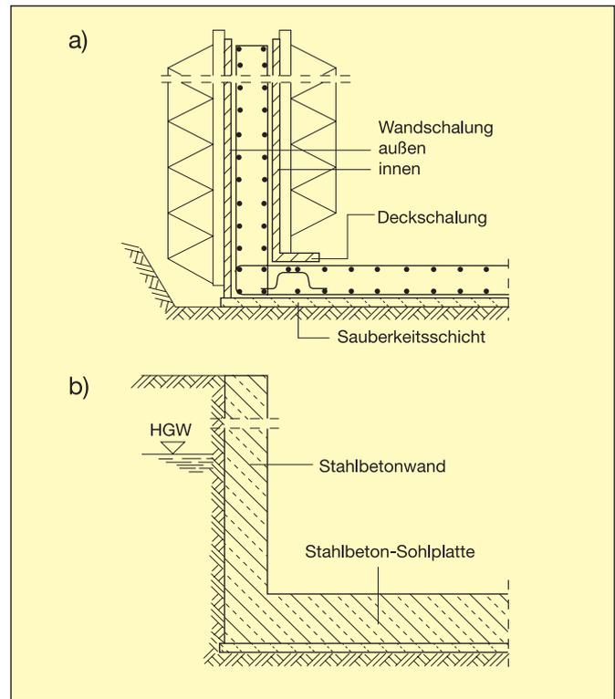
**Bild 3: Betonieren Sohlplatte – Wand in einem Arbeitsgang [1]**
