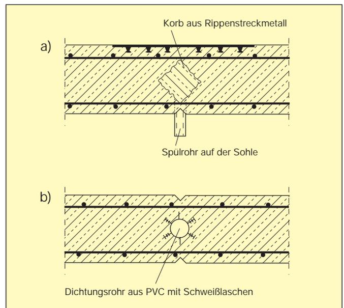
**Bild 7: Sollrissfugen in Wänden als Sollrissstelle zum Abbau von Zwangsspannungen [1]**
