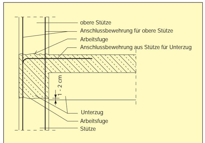
**Bild 10: Arbeitsfugen zwischen Stützen und Unterzügen**
