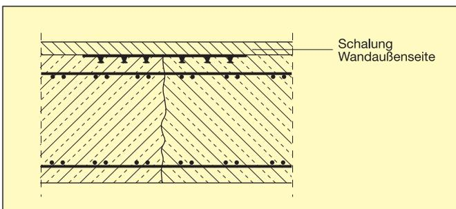
**Bild 5: Lotrechte Arbeitsfuge in der Wand, abgeschalt durch Rippenstreckmetall, gesichert durch ein außenliegendes Fugenband (waagerechter Schnitt) [1]**
