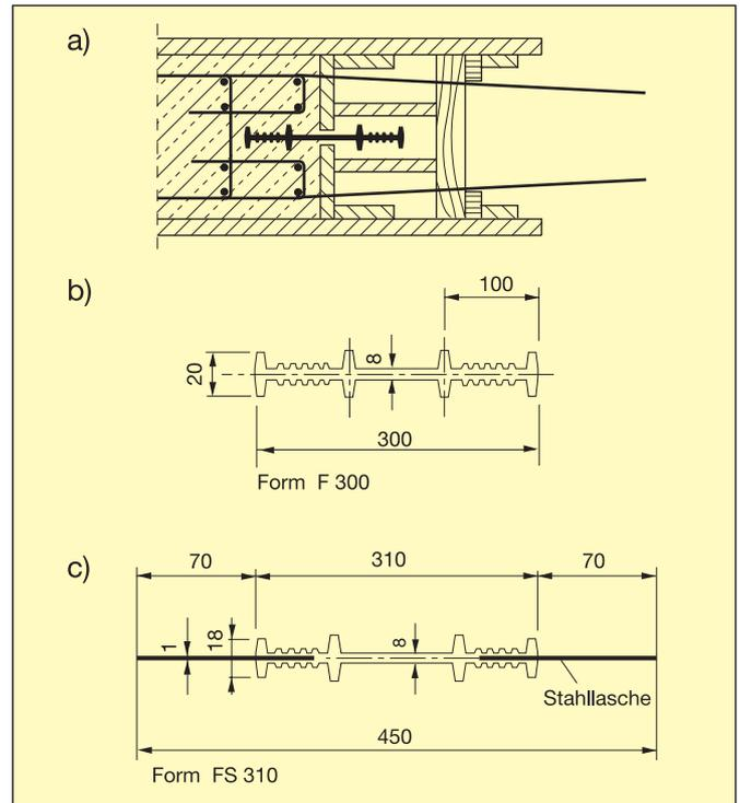
**Bild 6: Lotrechte Arbeitsfuge in der Wand, abgeschalt durch Brettschalung, gesichert durch ein mittiges PVC-weich Fugenband oder Elastomer-Fugenband [1]**
