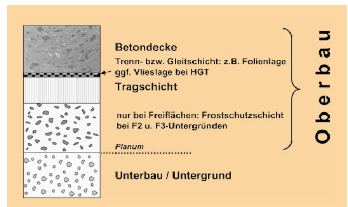
Bild 2: Aufbau eines Betonbodens
