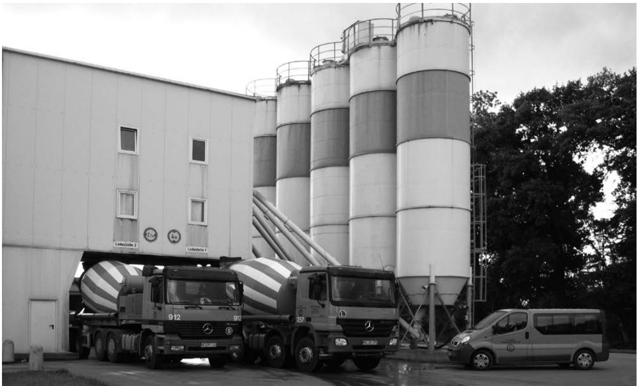
Bild 1: Lieferung von Transportbeton mit dem Fahrmischer
