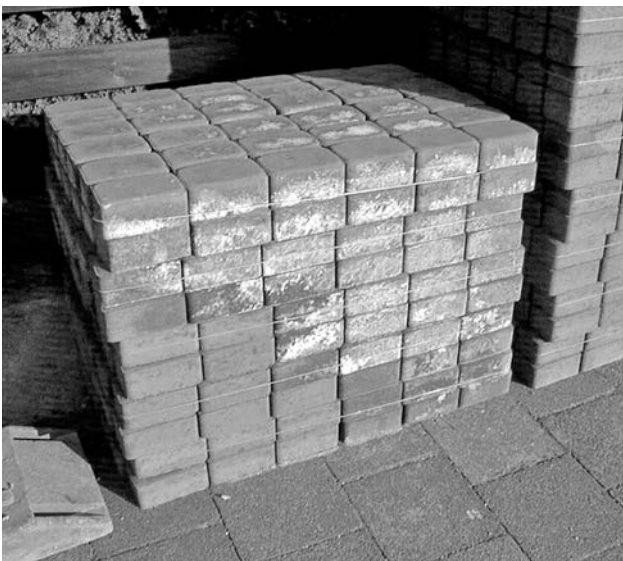
Bild 1: Ausblühungen an paketierten Pflastersteinen
