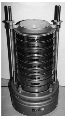
Bild 6: Siebmaschine nach DIN EN 933-1
