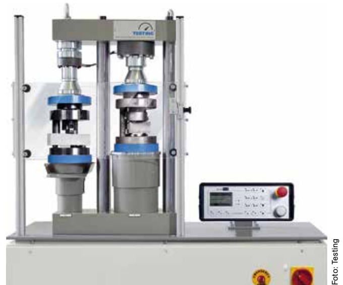
Bild 5: Prüfpresse zur Ermittlung der Betondruckfestigkeit
