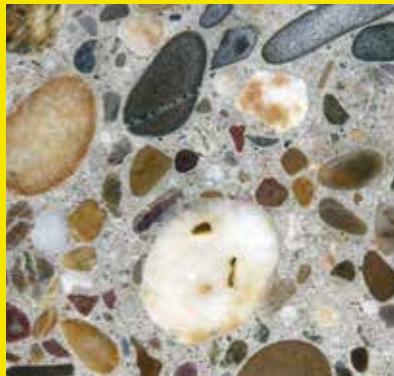
Bild 3: Schnitt durch Normalbeton, Schnitt durch gefügedichten Leichtbeton, Schnitt durch haufwerksporigen Leichtbeton (von oben nach unten)
