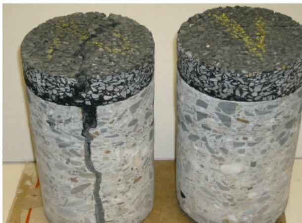
**Abbildung 5: Bohrkern «Dünne Asphaltbeläge auf Beton» (Foto: Straßen.NRW)**
