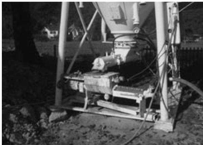
Bild 6: Durchlaufmischer und Schneckenpumpe am Trockenbetonsilo
