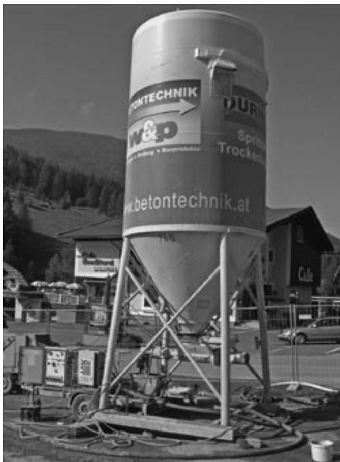
Bild 5: Trockenbetonsilo mit Misch- und Fördereinrichtung
