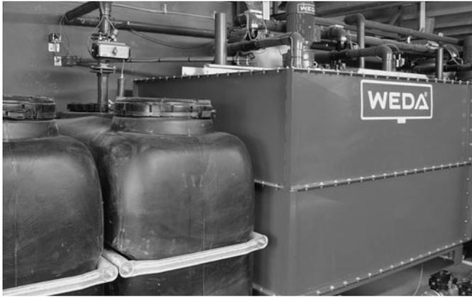
Bild 8: Computergesteuerte Futterküche für die Flüssigfütterung
