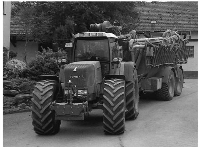
Bild 5: Moderner Traktor und Gülleanhänger mit einer Breite von 3 m und einem Gesamtgewicht von über 30 t
