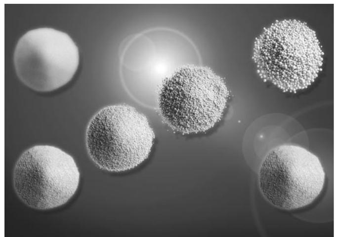
Bild 2: Blähglas als Ausgangsstoff für Leichtbeton
