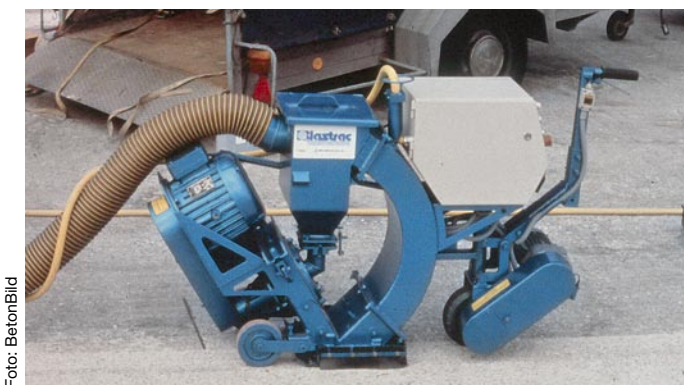
Bild 8: Vorbereitung des Untergrundes, z.B. mit Kugelstrahlen
