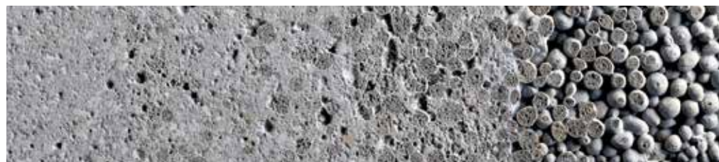
Unterschiedliche Porositäten, erzielt durch ein Schichtenverfahren
