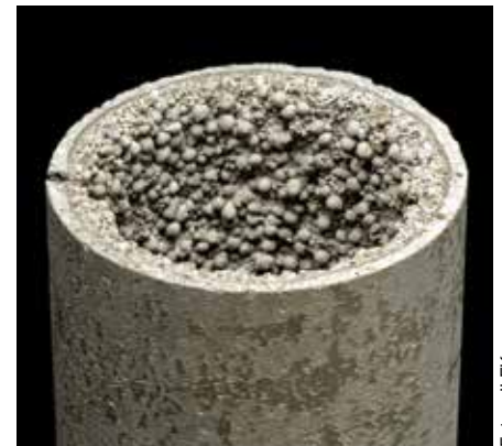
Porositätsgradient, kontrolliertes Entmischen, Rotationsverfahren
