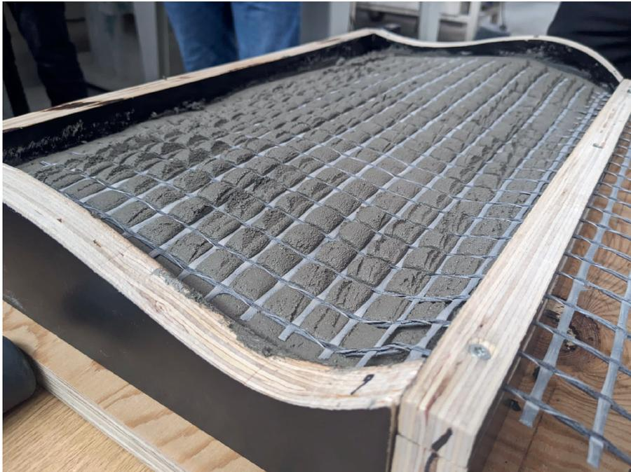
Bild 1: Herstellung eines geschwungenen Carbonbetonbauteils
