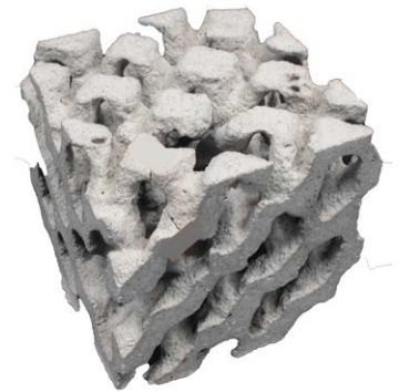
Komplexe Betonstruktur: Voll rezyklierbare Sandschalungen machen es möglich, mit überschaubarem Aufwand hochkomplexe Bauteile aus Beton herzustellen, die die hohe Präzision CNC-gesteuerter Fertigungsmethoden erfordern.
