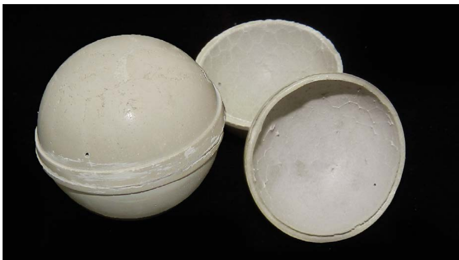
Betonhohlkugeln, hergestellt am ILEK. Die Wanddicke beträgt, je nach Erfordernis und gewünschter Robustheit, zwischen 1 mm und 4 mm, der Kugeldurchmesser maximal 250 mm. Beim Recycling punktet eine solche Monomaterialtechnologie, weil sie am Ende der Lebensdauer des Bauteils eine sortenreine Trennung ermöglicht.
