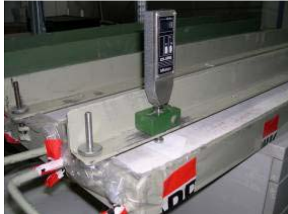
Abb. 11: Verformungsmessung am Schüsselbalken (100 x 15 x 5 cm)
