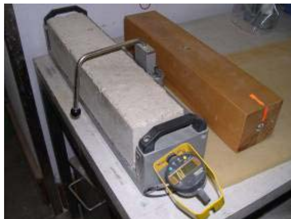
Abb. 12: Verformungsmessung am Schwindbalken (50 x 10 x 10 cm)
