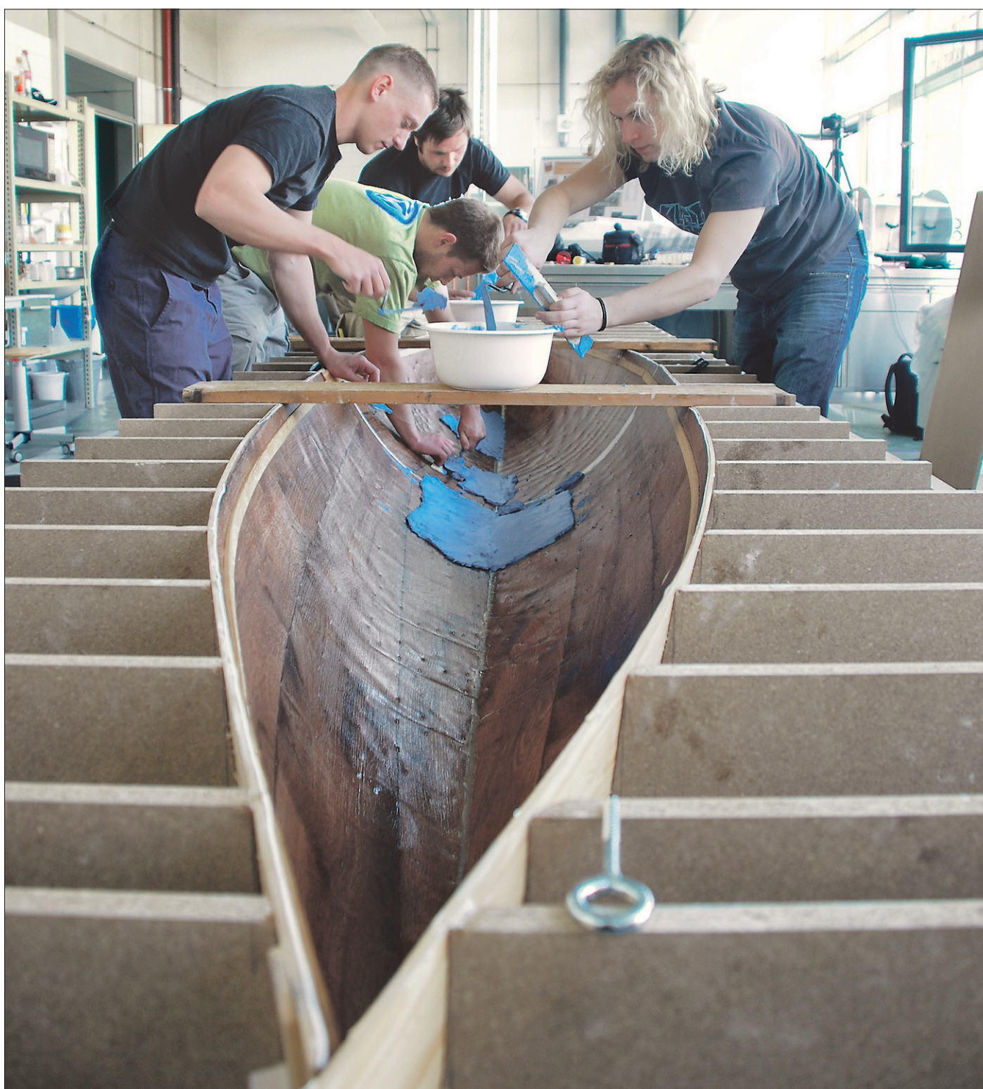
Thomas Pfeil (vorn l.) und Steffen Henning (r.) verteilen den blauen Beton in der Schalung. Diese wird nach dem Aushärten auseinandergeklappt und kann fürs nächste Boot verwendet werden. Fotos (2): Martin Rieß
