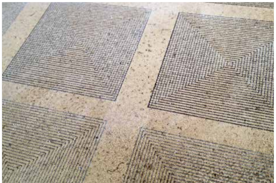
DysCrete ist ein Verfahrensansatz zur photoreaktiven Ertüchtigung (stromerzeugenden Veredelung) von Oberflächen aus Beton, der auf den Prinzipien der farbstoffsensitvierten Solarzelle (DYSC) beruht.
