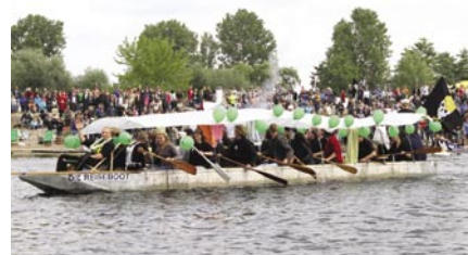
Mit „Die Reiseboot“, einem 2,8 Tonnen schweren, beinahe zwölf Meter langen und 1,80 Meter breiten Drachenboot aus 16 Betonelementen reisten die Dresdner nach Magdeburg. Foto: Victoria Kühne
