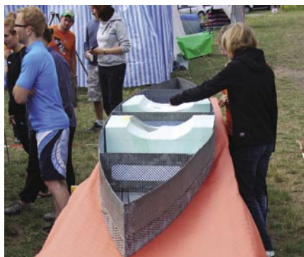
Das Kanu „Optimischt“ der ETH Zürich war – offensichtlich – das Boot mit der geringsten Wandstärke (2 mm) und mit nur 17,5 kg Gesamtgewicht das leichteste Boot der Regatta. Foto: BMN
